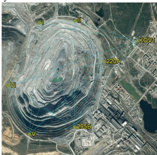
Рисунок 1.3 - Схема расположения фундаментальных реперов геомеханического полигона в карьере рудника «Железный»
