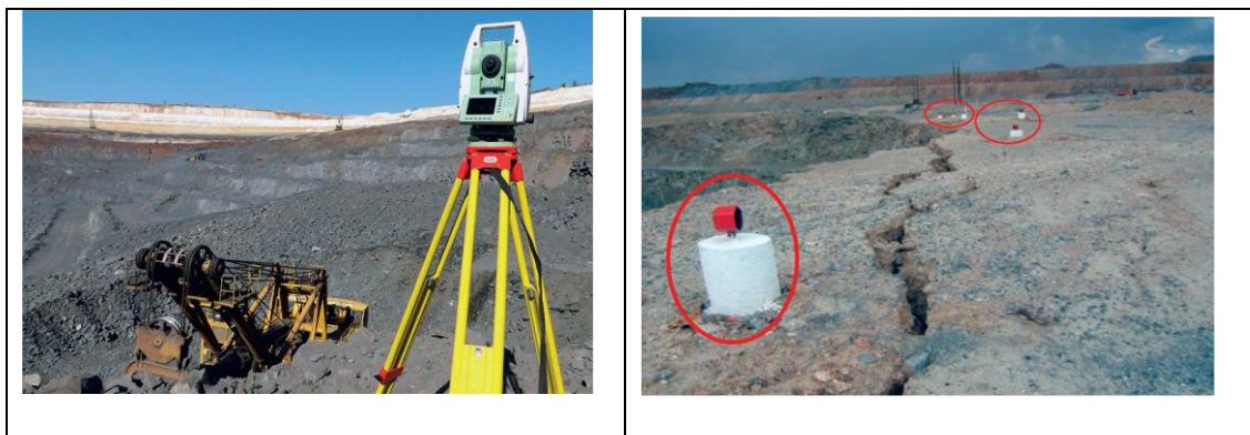
Рисунок 3.3 - Тахеометр-автомат (а) на борту карьера и отражающие призмы на опасном участке (б)
